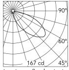
Luminous flux luminaire 523 lm
