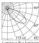
45° Beam Angle: h(m) E(lx) D(m) 173 2.68 1 2 5.36 43 3 19 8.04 4 11 10.71 5 7 13.39
