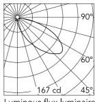
Luminous flux luminaire 523 lm
