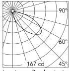
Luminous flux luminaire 523 lm
