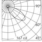
Luminous flux luminaire 523 lm
