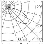
Luminous flux luminaire 277 lm
