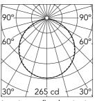
Luminous flux luminaire 714 lm
