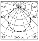
Luminous flux luminaire 714 lm
