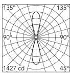
1427 cd 45° 5 Luminous flux luminaire 796 lm
