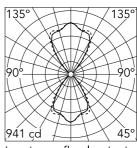
Luminous flux luminaire 2374 lm
