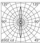
Luminous flux luminaire 1460 lm
