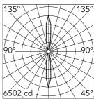
Luminous flux luminaire 1460 lm
