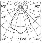
Luminous flux luminaire 348 lm
