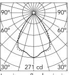
Luminous flux luminaire 348 lm
