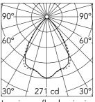
Luminous flux luminaire 348 lm
