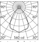
Luminous flux luminaire 740 lm
