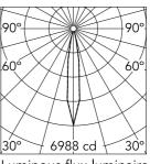
Luminous flux luminaire 781 lm
