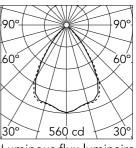
Luminous flux luminaire 740 lm
