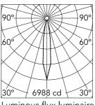
Luminous flux luminaire 781 lm
