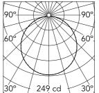
Luminous flux luminaire 703 lm
