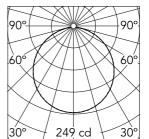
Luminous flux luminaire 703 lm
