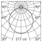
Luminous flux luminaire 613 lm
