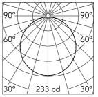
Luminous flux luminaire 658 lm
