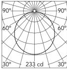
Luminous flux luminaire 658 lm
