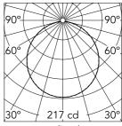
Luminous flux luminaire 613 lm
