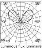
Luminous flux luminaire 898 lm
