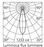
28° Beam Angle: h(m) E(lx)D(m) 1 1233 0.50 2 308 1.01 3 137 1.51 4 77 2.01 5 49 2.51
