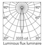
17° Beam Angle: h(m) E(lx)D(m) 1 3335 0.29 2 834 0.59 3 371 0.88 4 208 1.18 5 133 1.47
