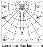
17° Beam Angle: h(m) E(lx)D(m) 1 3590 0.29 897 0.59 3 399 0.88 4 224 1.18 5 144 1.47
