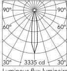
Luminous flux luminaire 393 lm
