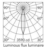
17° Beam Angle: h(m) E(lx)D(m) 1 3590 0.29 2 897 0.59 3 399 0.88 4 224 1.18 5 144 1.47
