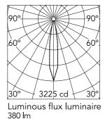
Beam Angle: h(m) E(lx)D(m) 1 3225 0.29 806 0.59 3 358 0.88 4 202 1.18 5 129 1.47
