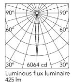
Beam Angle: h(m) E(lx)D(m) 1 6064 0.17 1516 0.34 3 674 0.51 4 379 0.68 5 243 0.84
