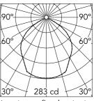
Luminous flux luminaire 631 lm
