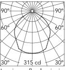
Luminous flux luminaire 703 lm
