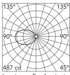
Luminous flux luminaire 607 lm
