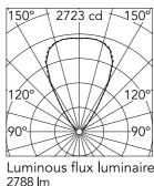
63° Beam Angle: h(m) E(Ix) D(m) 2723 1.23 1 2.46 2 681 3 303 3.69 170 4.92 4 5 109 6.15
