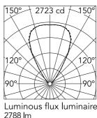
63° Beam Angle: h(m) E(lx) D(m) 2723 1.23 1 2.46 2 681 3 303 3.69 170 4.92 4 5 109 6.15
