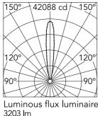
Beam Angle: 14° h(m) E(**l**x) D(m) 42088 0.25 1 10522 0.49 2 0.74 3 4676 4 2630 0.98 5 1684 1.23
