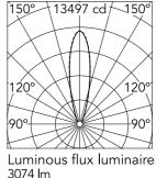
Beam Angle: 24° h(m) E(**l**x) D(m) 13497 0.43 1 0.86 2 3374 1.29 3 1500 1.73 4 844 5 540 2.16
