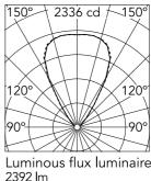
63° Beam Angle: h(m) E(lx) D(m) 2336 1.23 1 2.46 2 584 3 260 3.69 146 4.92 4 5 93 6.15
