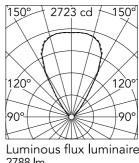
Beam Angle: 63° h(m) E(lx) D(m) 2723 1.23 1 2.46 2 681 3 303 3.69 170 4.92 4 5 109 6.15
