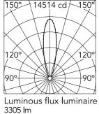
Beam Angle: 24° h(m) E(**l**x) D(m) 14514 0.43 1 0.86 3629 2 1.29 3 1613 907 1.73 4 5 2.16 581
