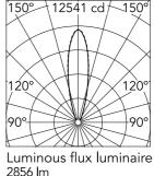
Beam Angle: 24° h(m) E(**l**x) D(m) 12541 0.43 1 0.86 3135 2 1.29 3 1393 1.73 4 784 5 502 2.16
