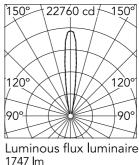
Beam Angle: 14° h(m) E(**l**x) D(m) 22760 0.25 1 0.50 5690 2 0.75 3 2529 4 1423 1.00 5 910 1.25
