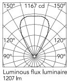
Beam Angle: 64° h(m) E(**l**x) D(m) 1167 1.25 1 2.49 2 292 3.74 3 130 73 4.98 4 5 6.23 47
