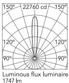
Beam Angle: 14° h(m) E(**l**x) D(m) 22760 0.25 1 0.50 5690 2 0.75 3 2529 4 1423 1.00 5 910 1.25
