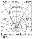
Beam Angle: 64° h(m) E(lx) D(m) 1350 1.25 1 2.49 2 338 3.74 3 150 4.98 4 84 5 6.23 54
