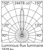
Beam Angle: 14° h(m) E(**l**x) D(m) 24478 0.25 1 0.50 6120 2 0.75 3 2720 4 1530 1.00 5 979 1.25
