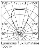
Beam Angle: 64° h(m) E(Ix) D(m) 1255 1.25 1 2.49 2 314 3.74 3 139 4.98 4 78 5 50 6.23
